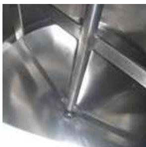
DETTAGLIO INTERNO DEL MISCELATORE CON PALE RASCHIANTI IN PTFE E FINITURA SUPERFICIALE LUCIDATA A SPECCHIO
