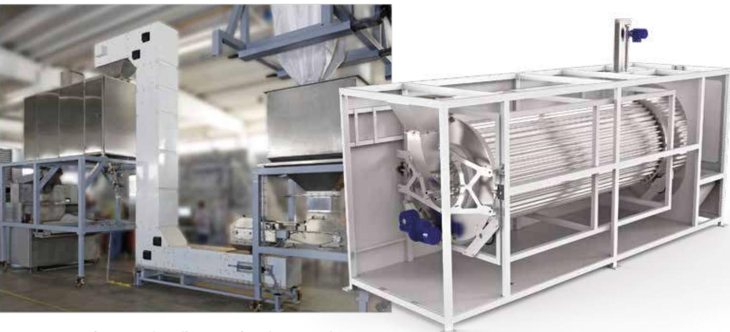
**Linea completa di tramoggia polmone per la ricezione del prodotto, nastro pesatore, elevatore, tamburo di trattamento e sistema di dosaggio**
