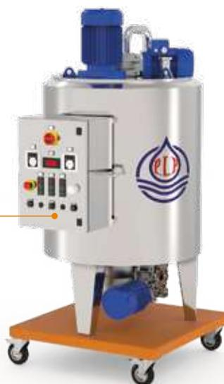
Fusore con camicia di riscaldamento, coibentazione e lamierino di protezione interamente saldato.
