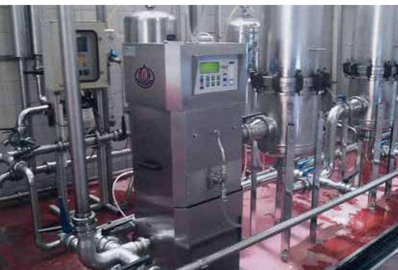
*Aggiunta proporzionale dopo la microfiltrazione in una linea di imbottigliamento*
